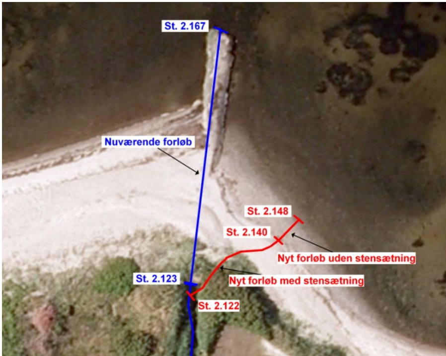
Figur 1. Tracé for den nuværende rørlagte strækning og for det nye åbne forløb.
